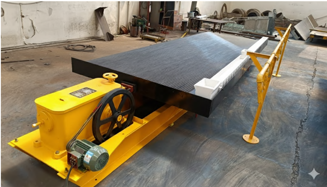
Imagen 2: Mesa gravimétrica XL-100 (2.5 ton/hr) armada con canales de distribución de plástico ABS.
