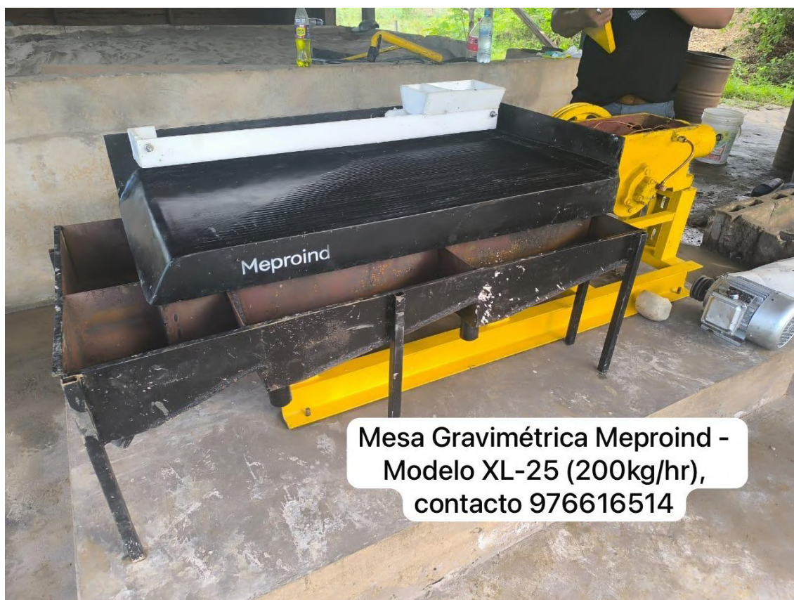
Imagen 1: Mesa gravimétrica XL-25 instalada en Madre de Dios (Año 2025)
